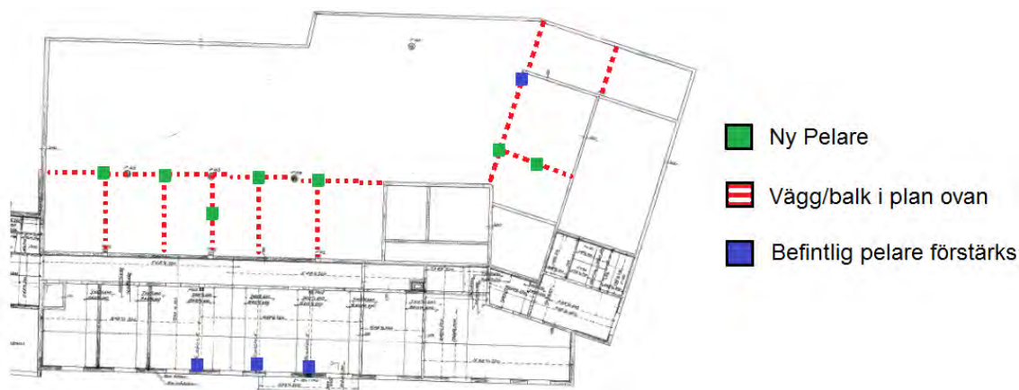
Figur 3.10: Förstärkningsåtgärder i grundplan i fastighet 4:12b
