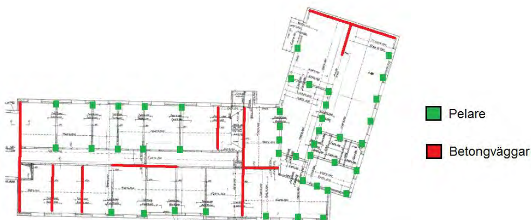
Figur 3.8: Princip på tillbyggnad av fastighet 4:12b
